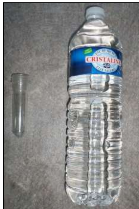
Fig. 3 : La préforme de la bouteille (à gauche) prend la forme d'une bouteille par chauffage et soufflage dans un moule puis est remplie d'eau en une seconde
